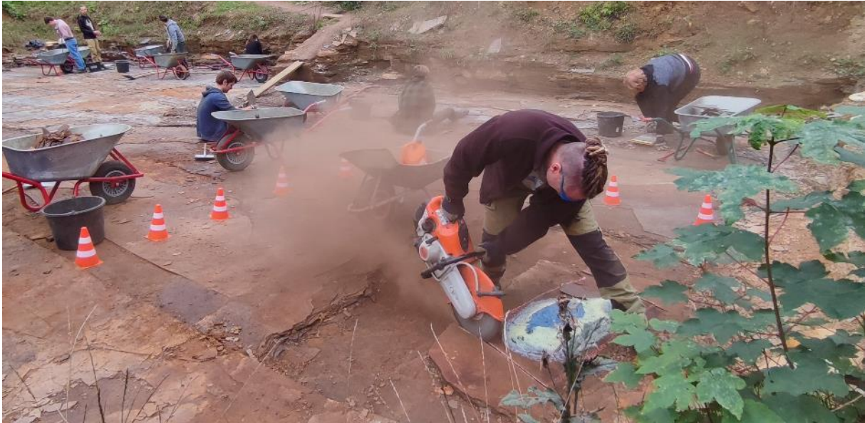
Abb. 4: Um das Fischfossil herum wird das Gestein mittels einer Gesteinsflex geschlitzt, um die umliegenden Tonsteinbereiche sauber abtragen zu können.
