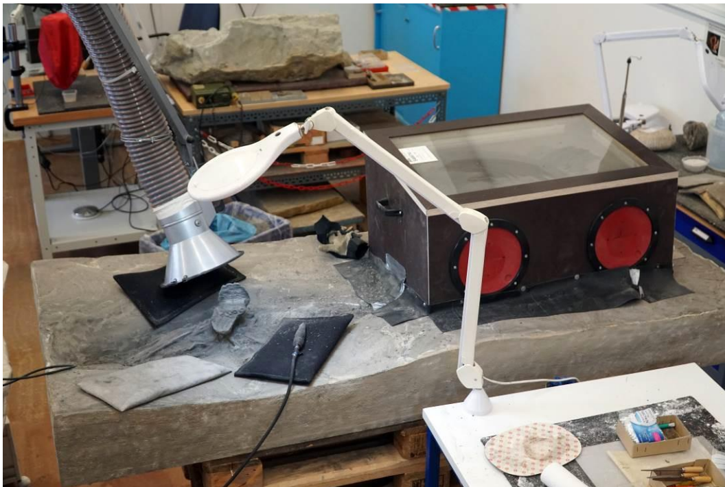
Speziell angefertigte Sonderkonstruktion zum Sandstrahlen der empfindlichen Knochenoberflächen des Ichthyosaurier-Exemplars „Creedence“.
